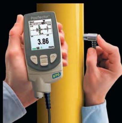
UTG ME 型--具有穿过涂层的操作模式，在被测物表面有油漆时，无需去除油漆而测量材料的净厚度
