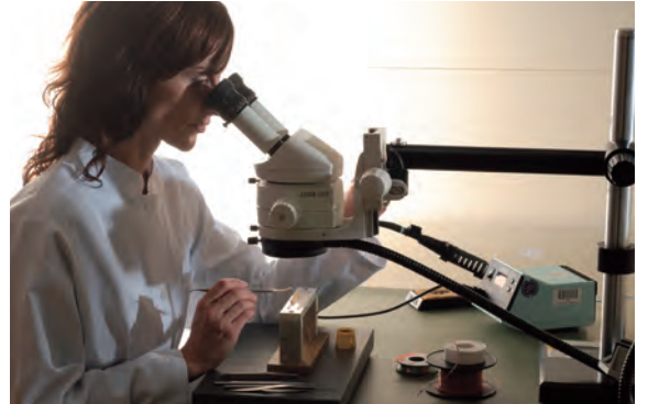
在显微镜下制作探头
